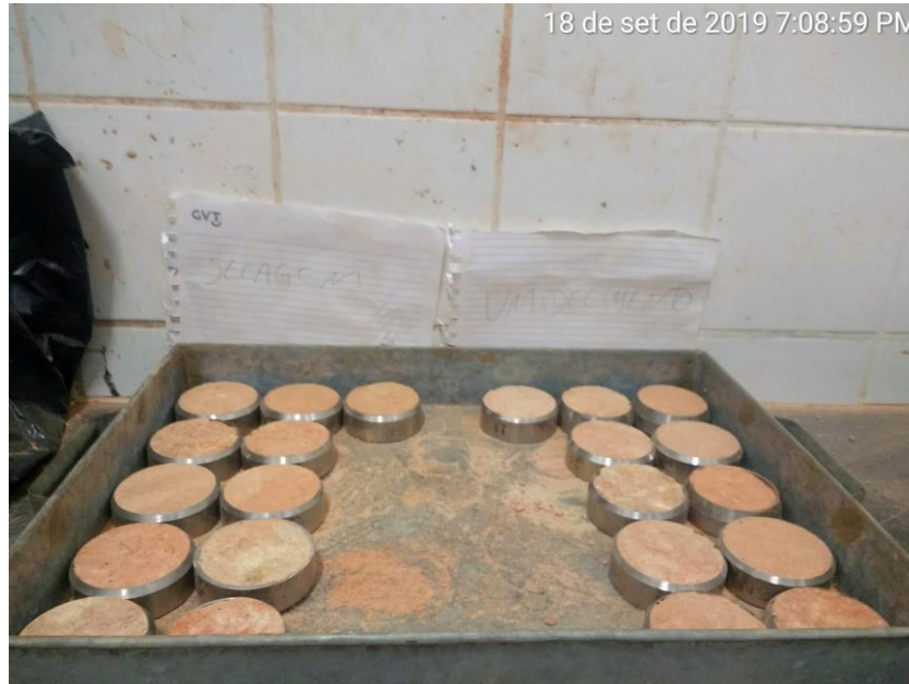
Figura 3.7: Corpos de Prova moldados para o ensaio de papel filtro
