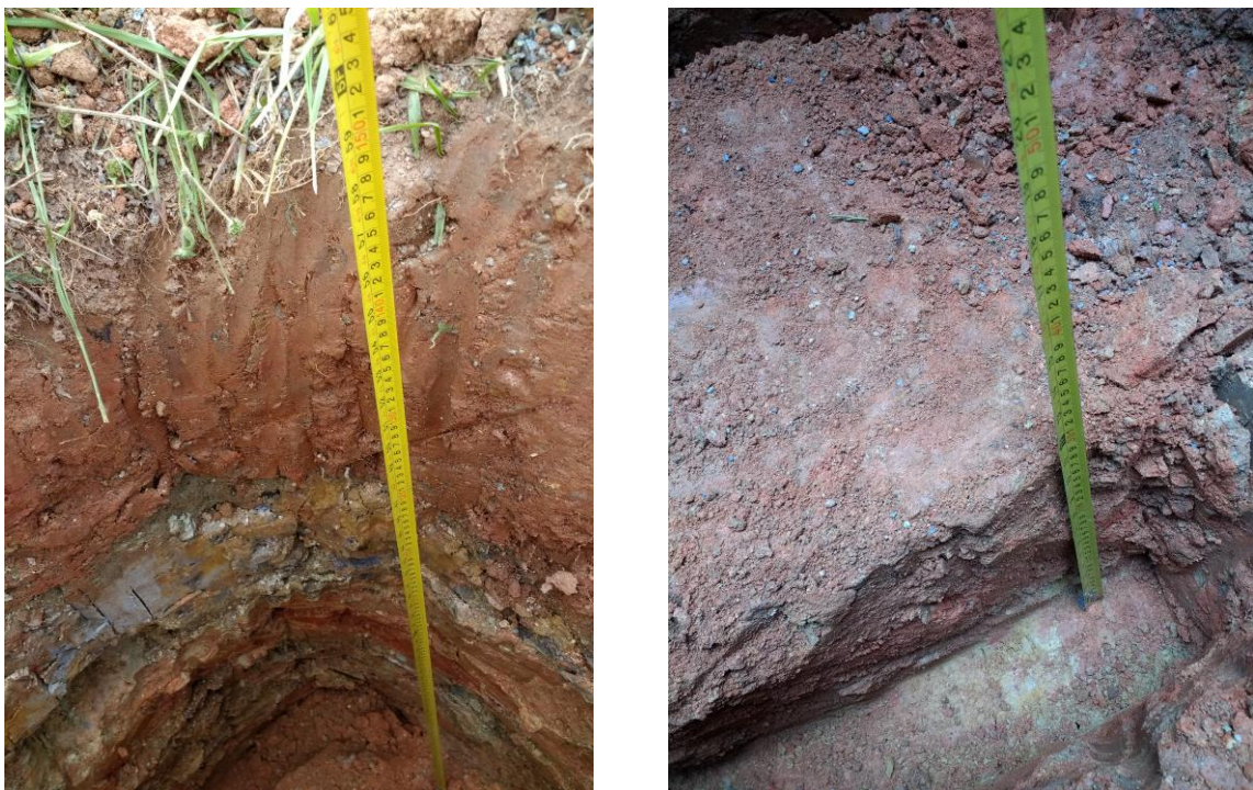
Figura 3.6: Coleta de amostras indeformadas/deformadas no Q-10 (Amostra Indeformada 01).
