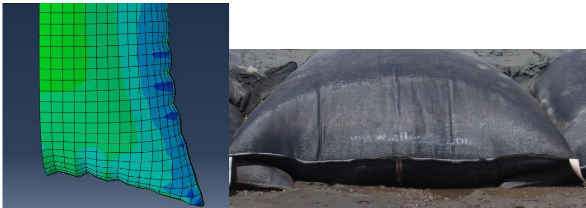
Figura 4.26 – Extremidade onde o tubo geotêxtil dobra
