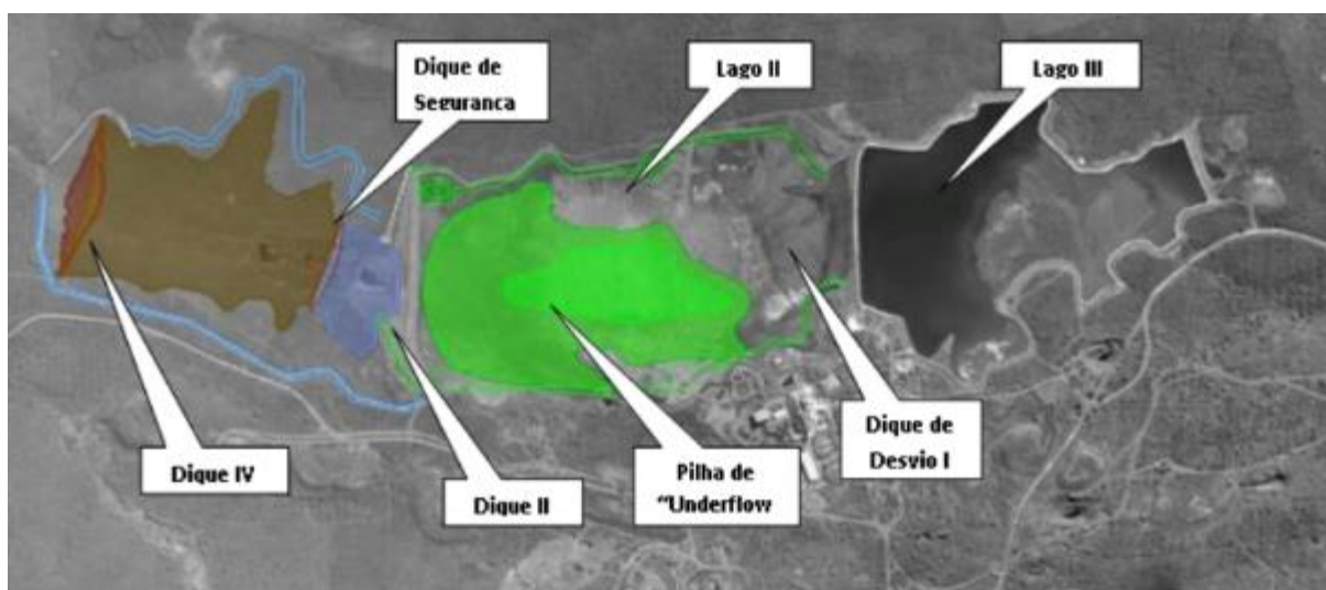
Figura 4.12: Sistema de disposição de rejeito da área de estudo (SANTOS, 2014).
