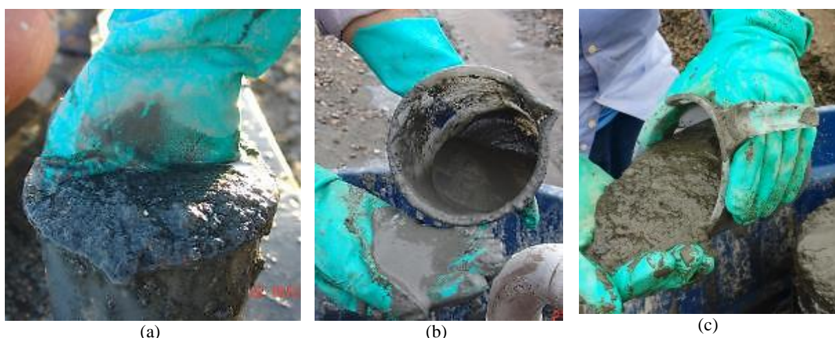
Figura 5.18: Aspecto do comportamento do polímero e rejeito. Em (a) excesso de polímero na mistura, em (b) quantidade de polímero insuficiente e em (c) proporção adequada de polímero.
