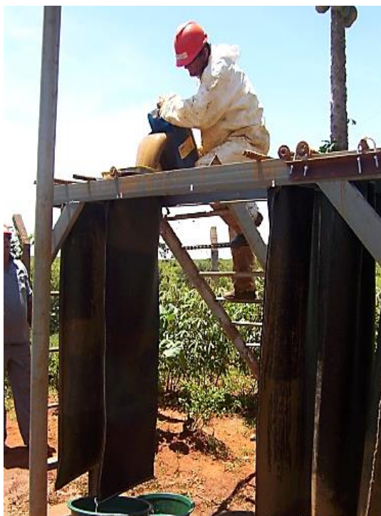
Figura 3.33: Montagem e execução do ensaio de Bolsa Suspensa de Geotêxtil (MARTINS, 2006).
