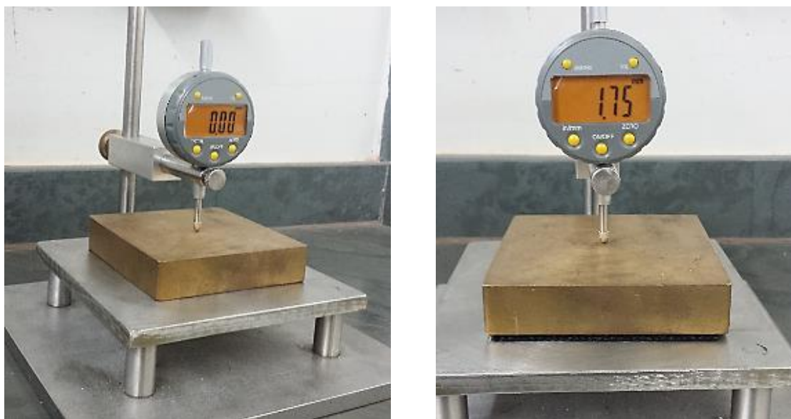
Figura 4.19: Obtenção da espessura nominal do geotêxtil a partir da base de peso equivalente a 2 kPa apoiada sob o geotêxtil.
