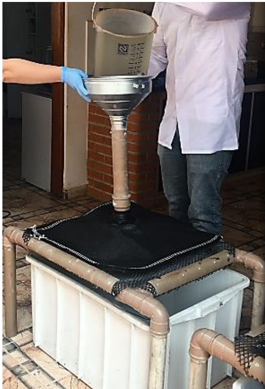
Figura 4.21: Montagem do ensaio de bolsa fechada de geotêxtil.
