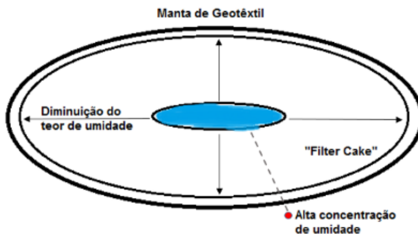
Figura 3.17: Formação do “ filter cake ” e distribuição do teor de umidade no interior do tubo (adaptado de CASTRO, 2005).
