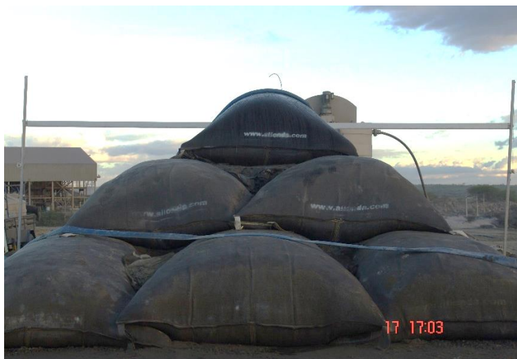
Figura 5.34: Segunda fase de empilhamento dos tubos geotêxteis e finalização do protótipo de campo.
