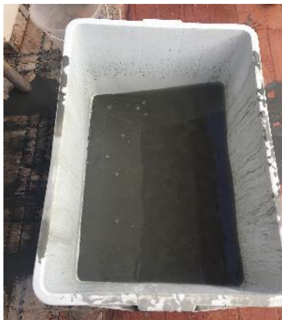
Figura 5.11: Aspecto final do percolado retido no recipiente coletor.
