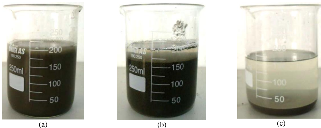
Figura 5.8: Amostra com adição do polímero aniônico Axflor AP 1110 a 0,1%. Em (a) recipiente com amostra bruta, em (b) amostra com formação de floculado após a adição do polímero e em (c) aspecto final do efluente percolado.
