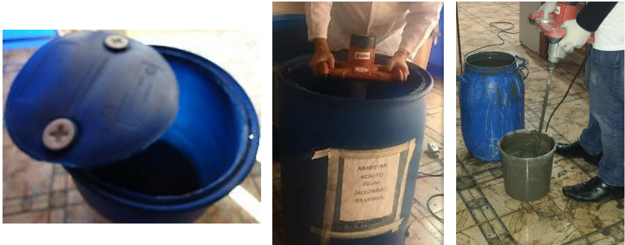
Figura 4.20: Abertura da bombona e homogeneização do rejeito com misturador.
