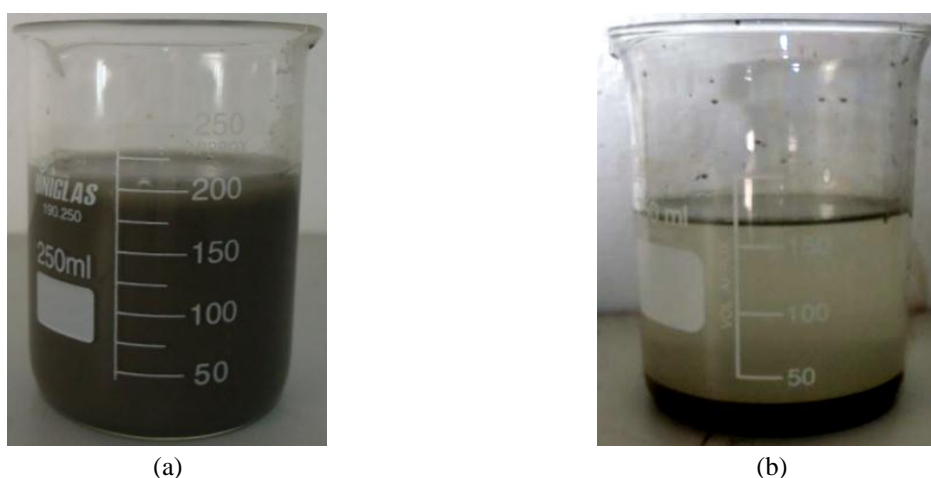
Figura 5.9: Em (a) amostra de rejeito bruto a ser ensaiada e em (b) amostra final do percolado.
