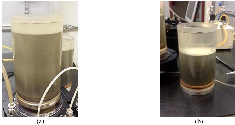
Figura 4.16: (a) Corpo de prova para a fase de sedimentação (Fase 1) após sua preparação; (b) corpo de prova após 18 horas em repouso para sedimentação.
