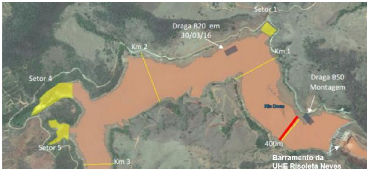
Figura 3.11: Vista geral dos setores de dragagem e disposição de sedimentos no reservatório da UHE Risoleta Neves (Candongas) (SAMARCO, 2016).
