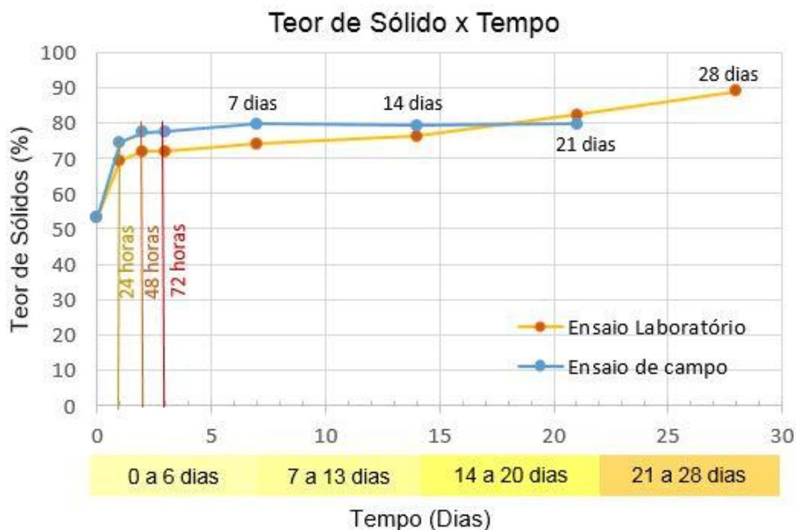
Figura 5.31: Variação do teor de sólidos do rejeito em função do tempo (dessecamento), em amostras coletadas no ensaio de grande escala (ensaio de campo) e ensaio de laboratório (GDT).
