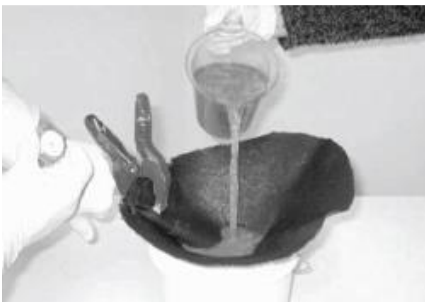
Figura 3.31: Montagem e vertimento da mistura no ensaio de Cone de Geotêxtil (LAWSON, 2006)
