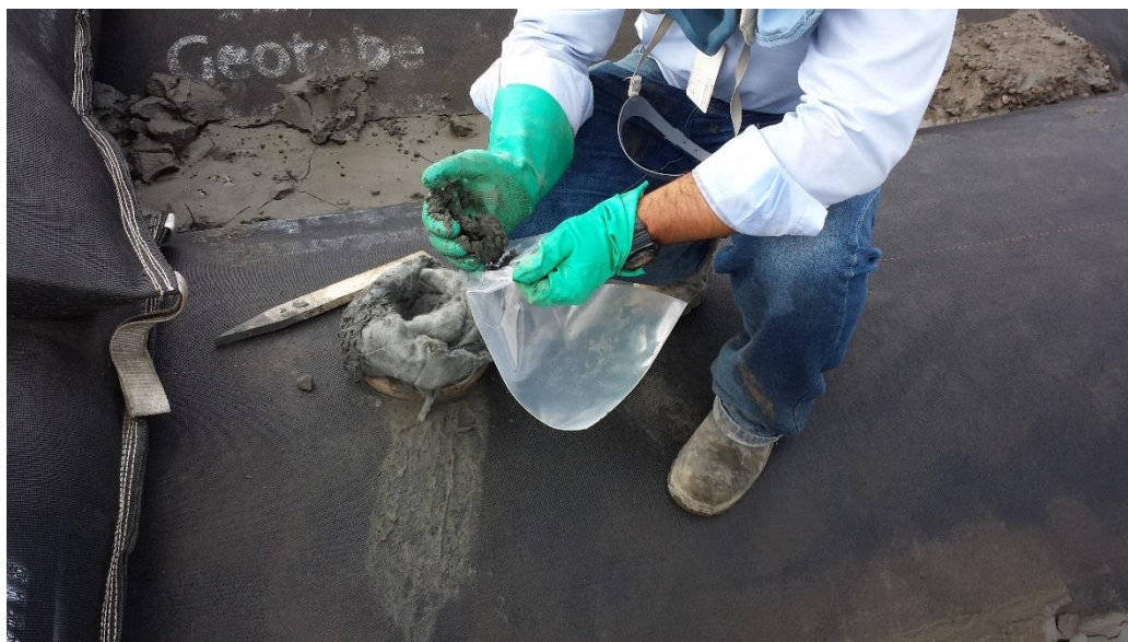
Figura 5.30: Coleta de amostra de rejeito contido no interior do tubo geotêxtil.
