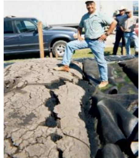
Figura 3.36: (a) Ensaio de protótipo em grandes dimensões; (b) consistência da polpa de ETE 24 horas após desaguamento e remoção do tubo geotêxtil (adaptado de FOWLER, LARKINS E DUKE, 2005).
