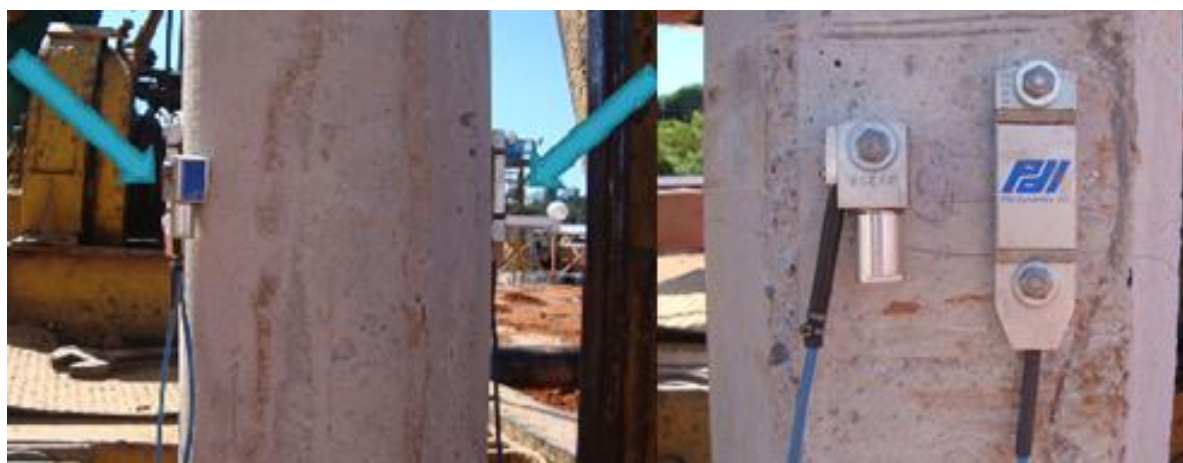
Figura 2.15: Instrumentação da estaca para medições de força e aceleração da onda.
