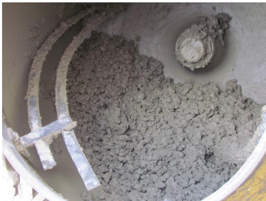
Figura 3.13: Homogeneização da bucha de concreto com betoneira elétrica
