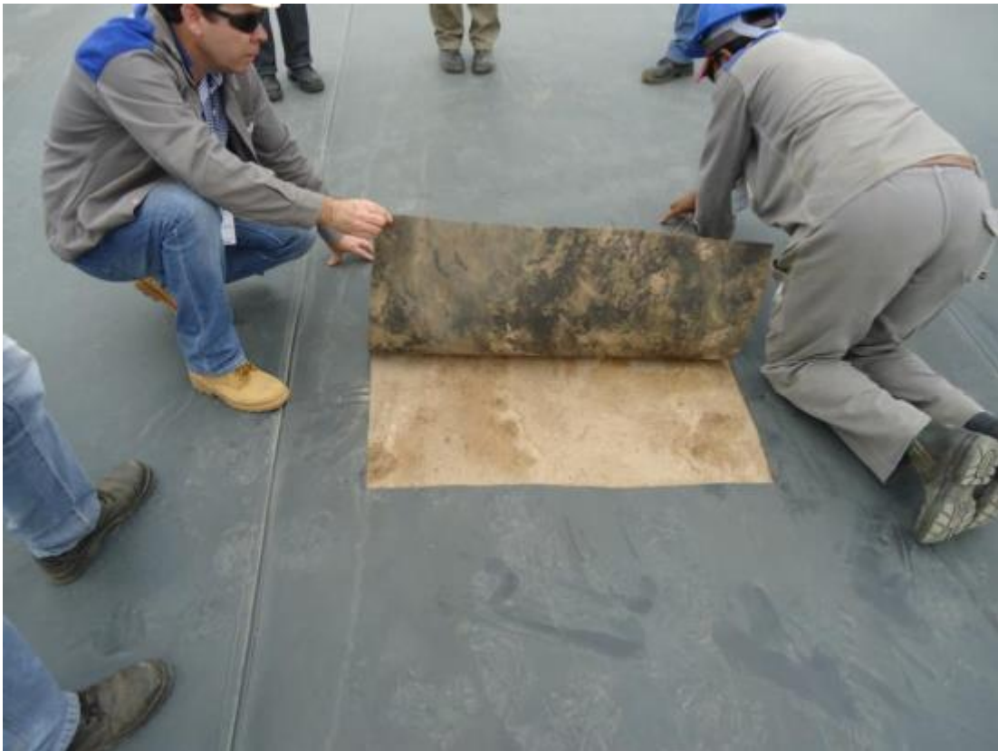
Figura 3-27 – Lago II – Exumação da amostra de PVC – Amostra GMEX-D
