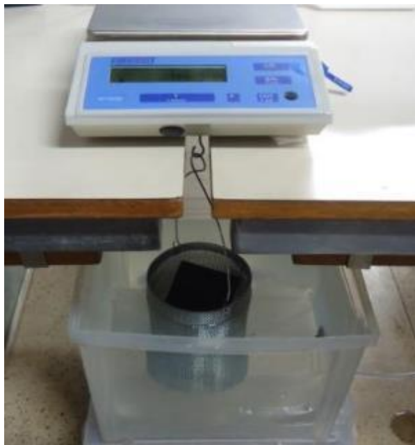
Figura 3-38 – Balança para determinação da densidade
