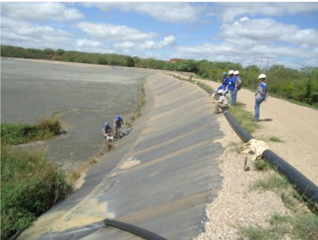
Figura 3-28 – Lago III – Exumação da amostra de PVC – GMEX-B e GMEX-C
