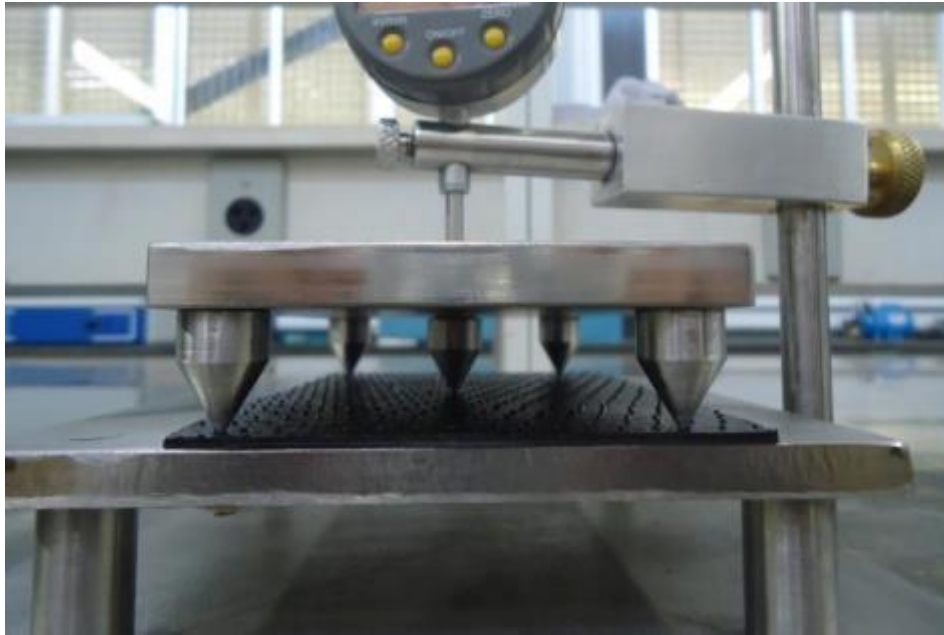
Figura 3-37 – Detalhe da medição da espessura do núcleo de geomembrana texturizada em uma face (GARDONI, 2013)
