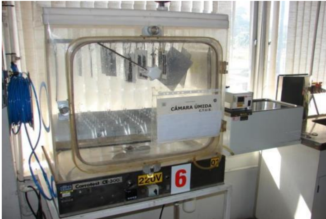
Figura 3-30 - Vista geral da câmara úmida – Fabricante Corrotest CE300
