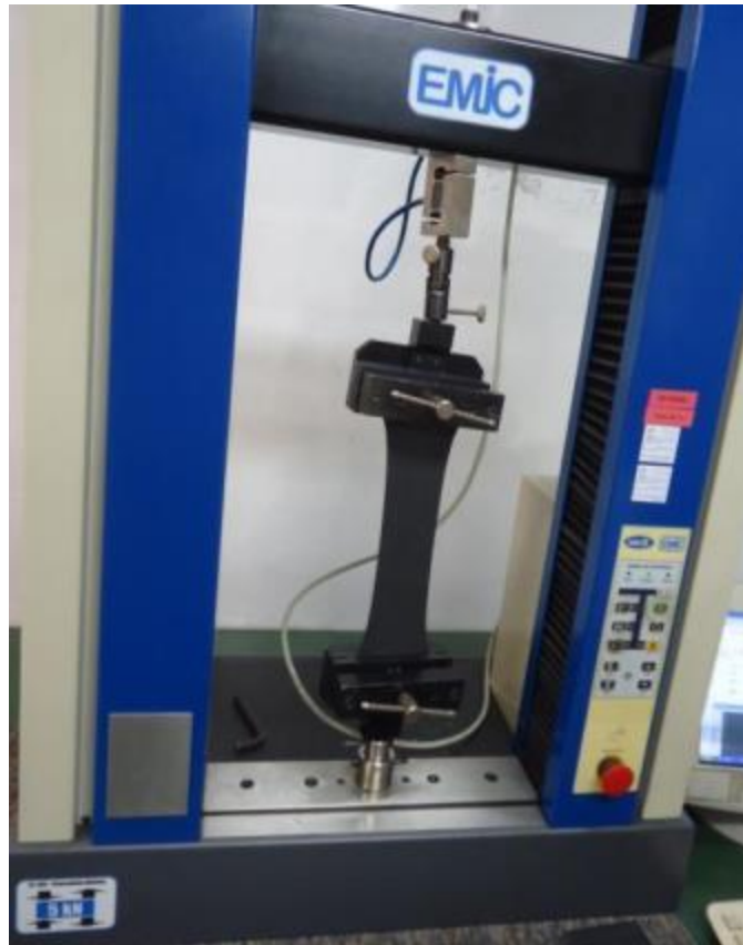
Figura 2.6 – Ensaio de tração em geomembrana de HDPE
