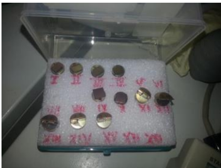
Figura 3-44 – Amostras metalizadas com ouro
