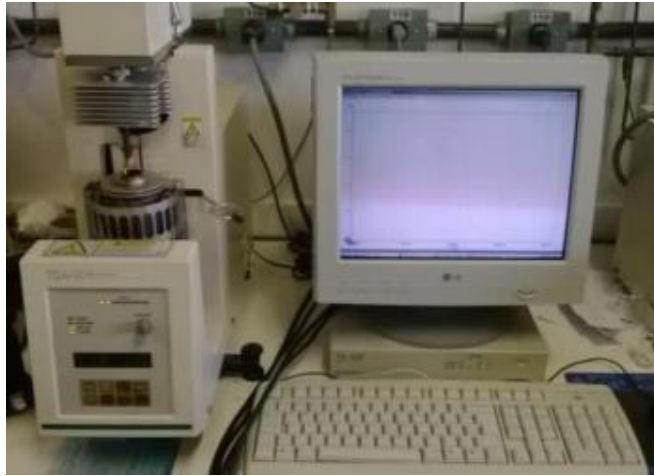
Figura 3-39 - Equipamento de termogravimetria e computador para aquisição dos dados
