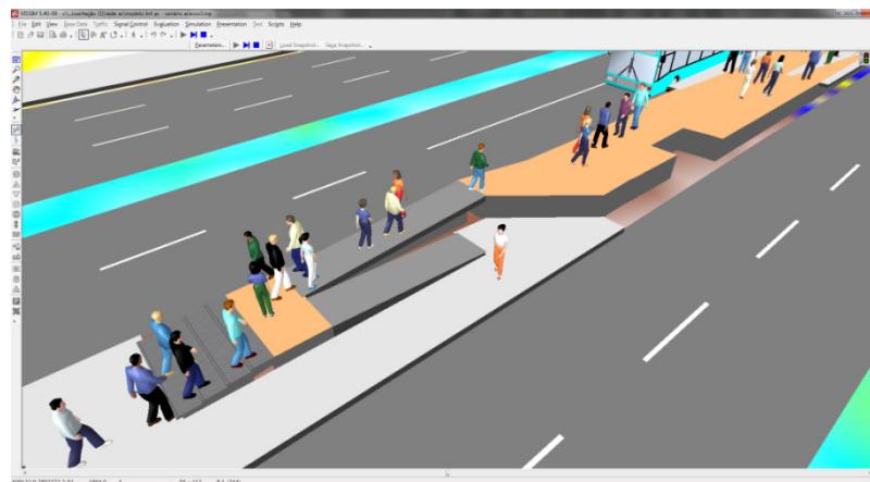
Figura 4.31 – Configuração da rampa no cenário ACESSO3
