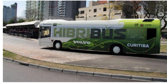
Figura 2.24 – Primeiro ônibus Híbrido (eletricidade/biodiesel) da Volvo – Curitiba Fonte: Blog Rotas Estratégicas – Setor de Energia ( http://rotaenergia.wordpress.com ).
