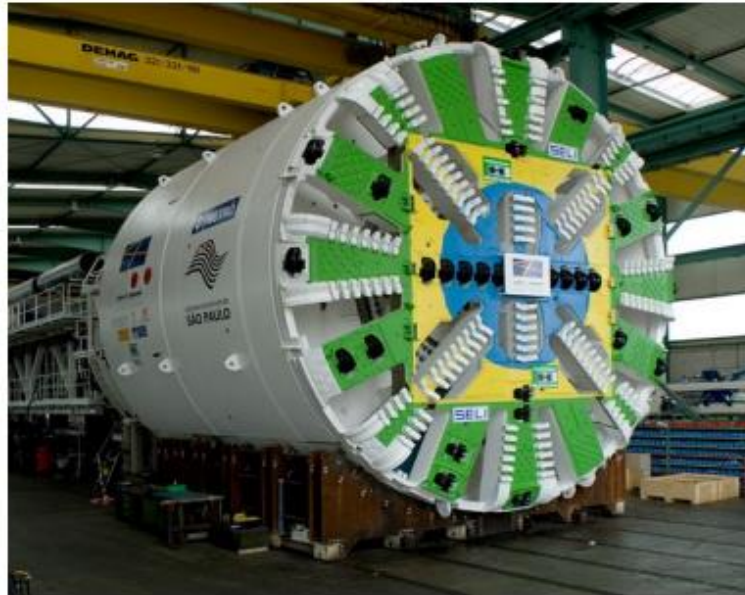
FIGURA 2.2 Tuneladora EPB utilizada na abertura dos túneis da Linha 4 do metrô de São Paulo (Assis, 2010)
