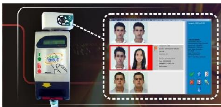
FIGURA 4.4 – Câmera acoplada ao validador para captura de imagem Fonte: Tacom Engenharia e Projetos Ltda
