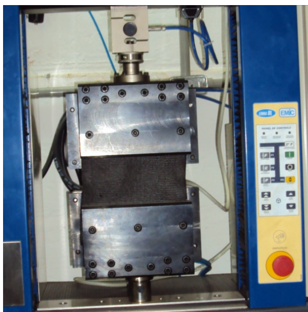
FIGURA 4.15 – Amostra de geotêxtil fixada às garras de tração.
