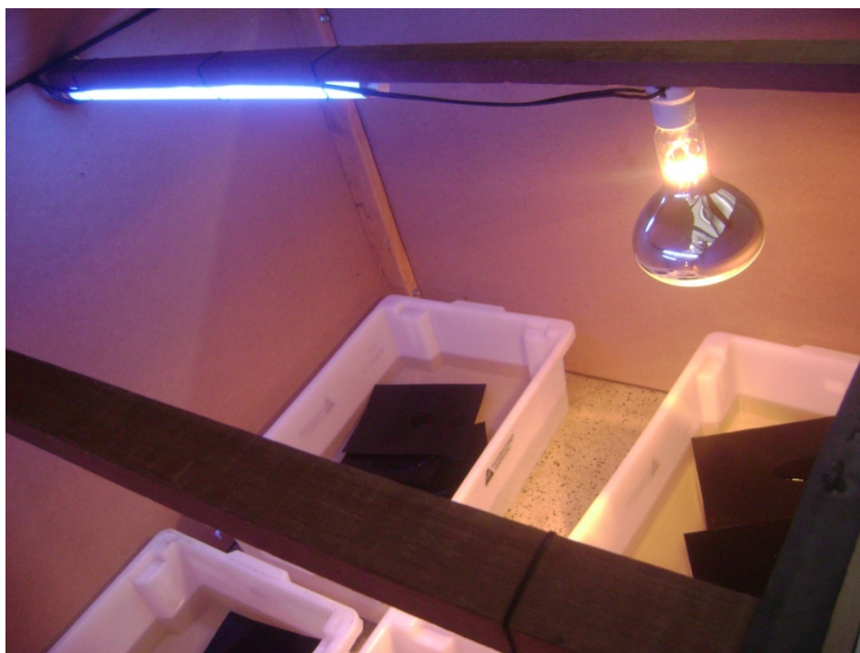
FIGURA 4.13 – Vista da estufa utilizada nos ensaios de durabilidade da geomembrana.
