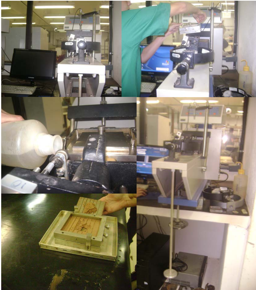
FIGURA 4.6 – Ensaio de cisalhamento direto.
