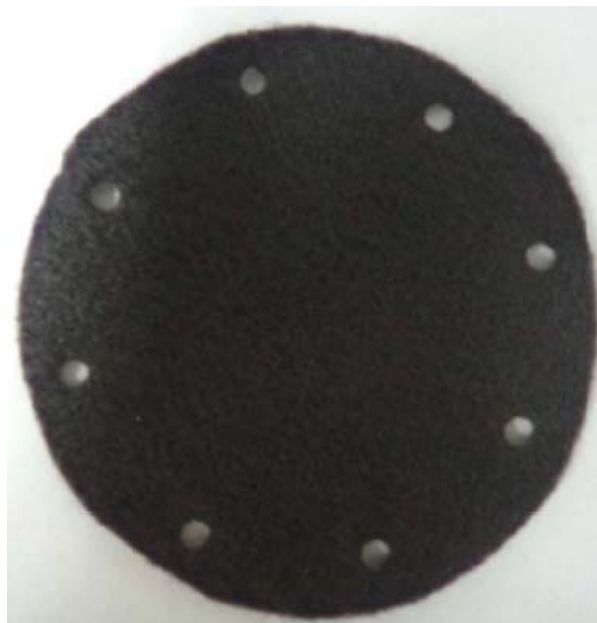
FIGURA 5.16 – Geotêxtil antes do ensaio de dano mecânico.
