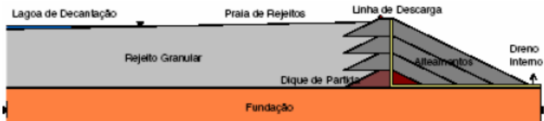
FIGURA 2.3 – Método construtivo da linha de centro (ALBUQUERQUE FILHO, 2004).
