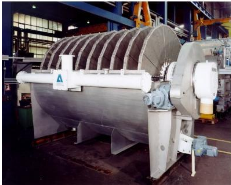
FIGURA 2.9 – Filtro de disco convencional Modelo VSF 120/10 (GUIMARÃES, 2011).
