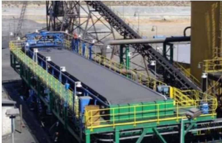
FIGURA 2.10 – Filtro horizontal de correia (GUIMARÃES, 2011).
