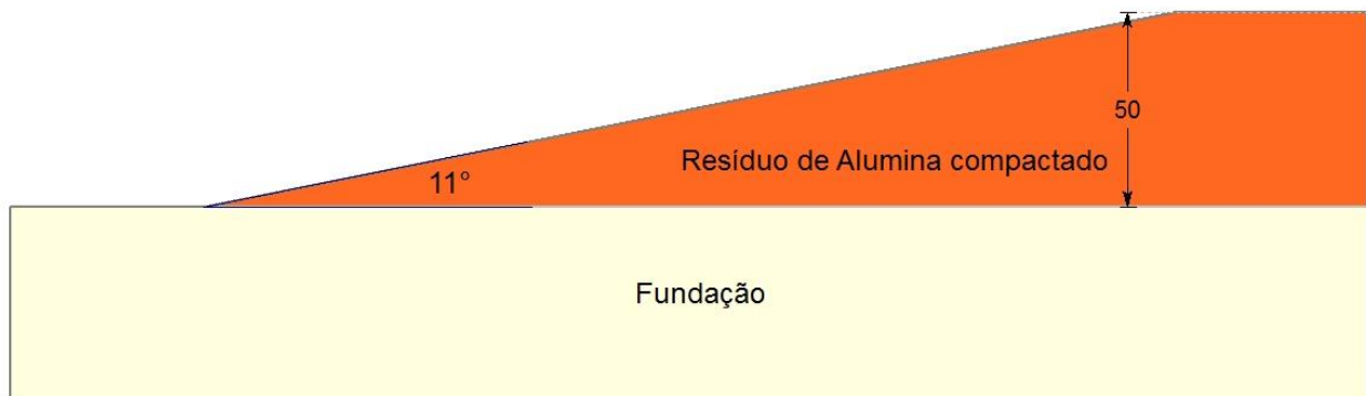
FIGURA 4.22 – Pilha de resíduos com 50m de altura e inclinação global do talude de 11°
