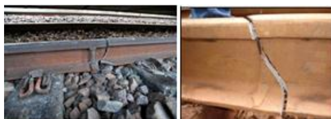
FIGURA 3.19 - Fratura de trilho. (FONTE – AAR, 2010).
