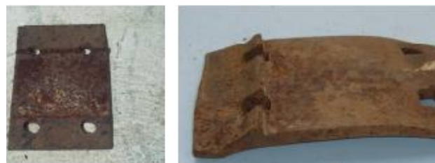
FIGURA 3.21 - Empeno das placas de apoio. (FONTE – AAR, 2010).
