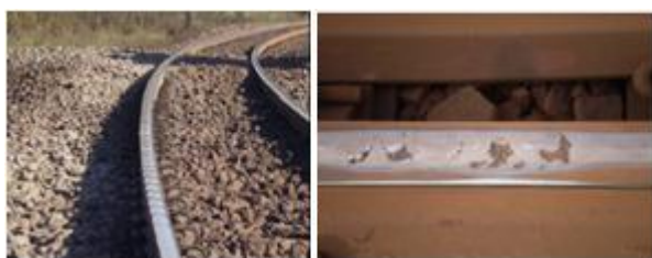
FIGURA 3.18 - Defeitos superficiais. (FONTE – AAR, 2010).
