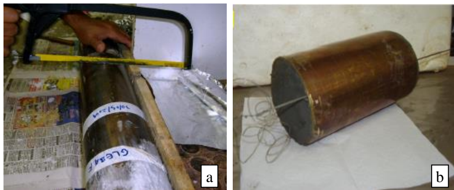
FIGURA 2.1 - Procedimento de extrusão e preparação de corpos de prova de solos moles em laboratório (Baroni, 2010)
