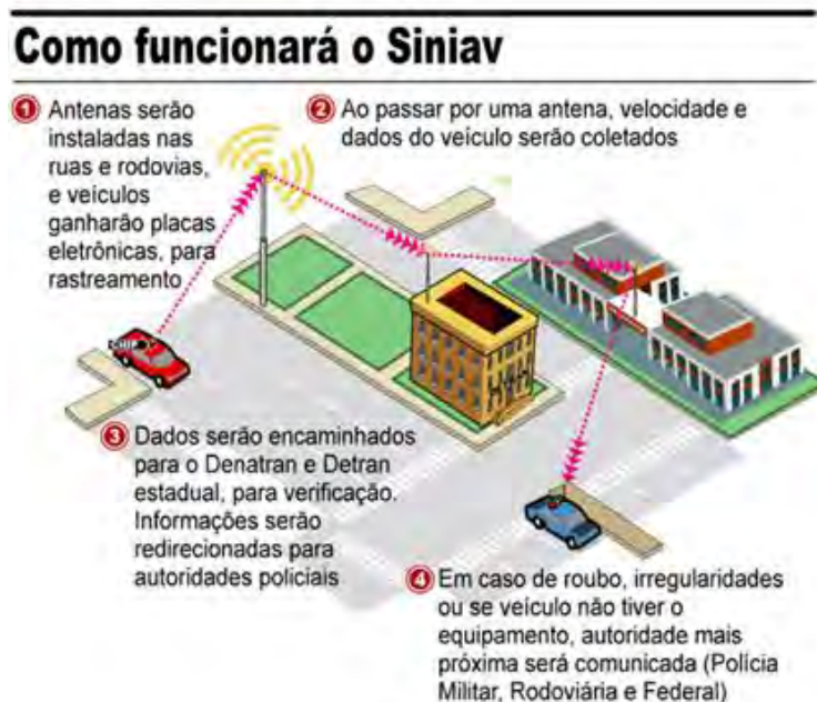
Figura 24 – Funcionamento do SINIAV
