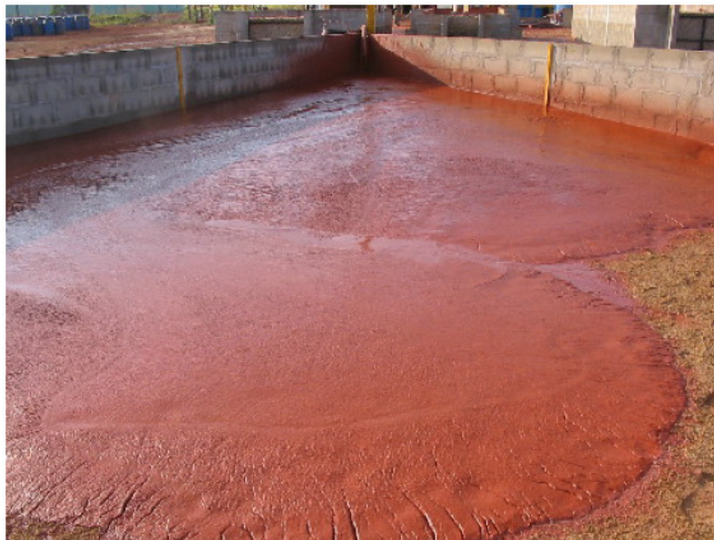
FIGURA 2.16 – Flume test sendo conduzido para determinação do ângulo de disposição (Fonte: Slottee, Johnson e Crozier, 2008)
