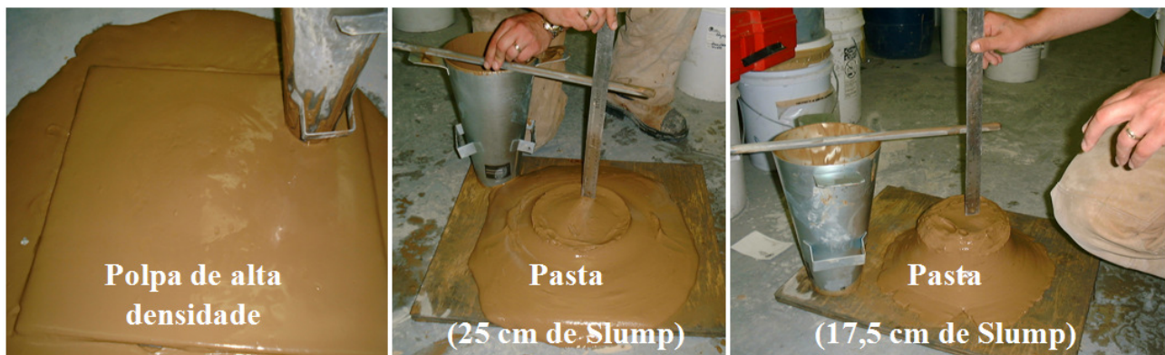
FIGURA 2.14 – Slump test sendo realizado para um mesmo rejeito e diferentes teores de sólido em peso (Fonte: Grabinsky, Theriault e Welch, 2002)
