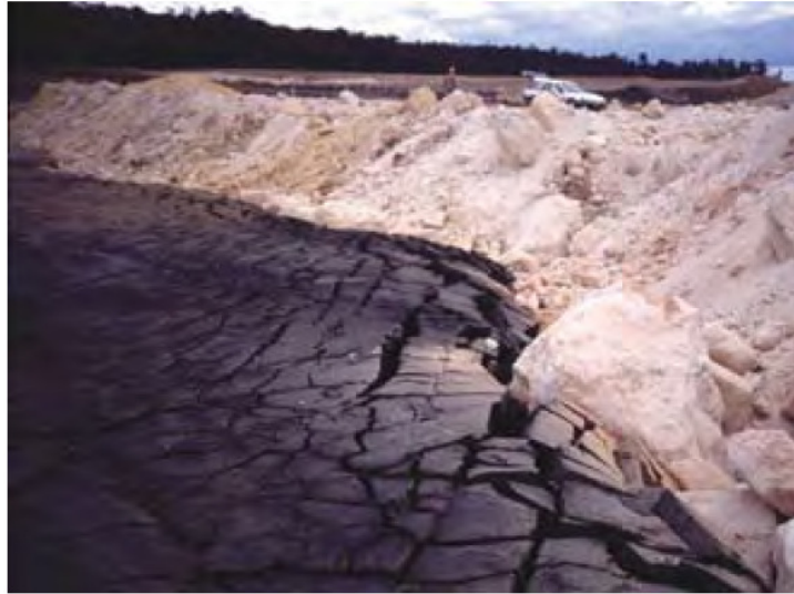
FIGURA 2.10 – Disposição compartilhada de rejeitos e estéreis (Fonte – Australian, 2007)
