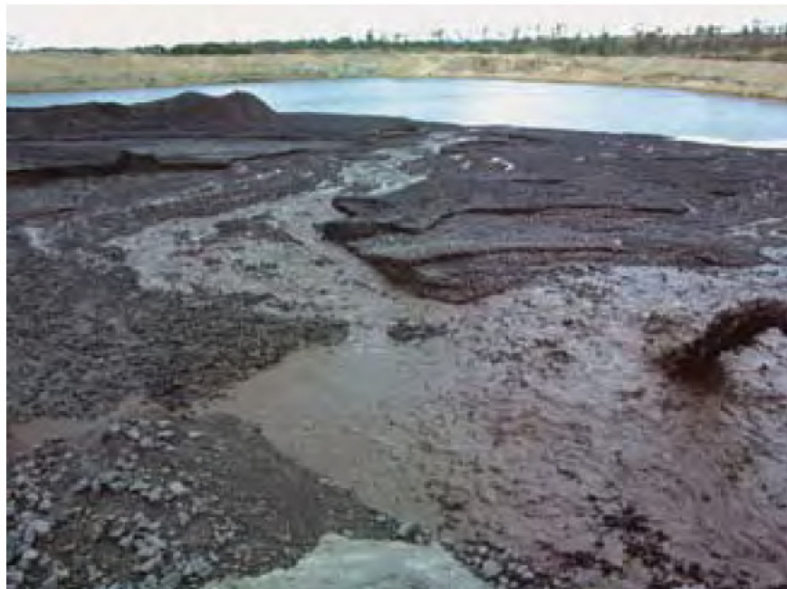
FIGURA 2.11 – Codisposição de rejeitos granulares e finos (Fonte – Australian, 2007)
