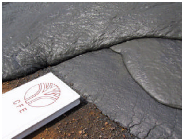
(c) Três camadas finas de pasta sobrepostas.
