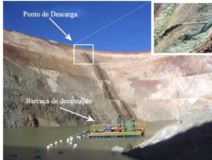
FIGURA 2.9 – Disposição em pit (Fonte – Lozano, 2006)
