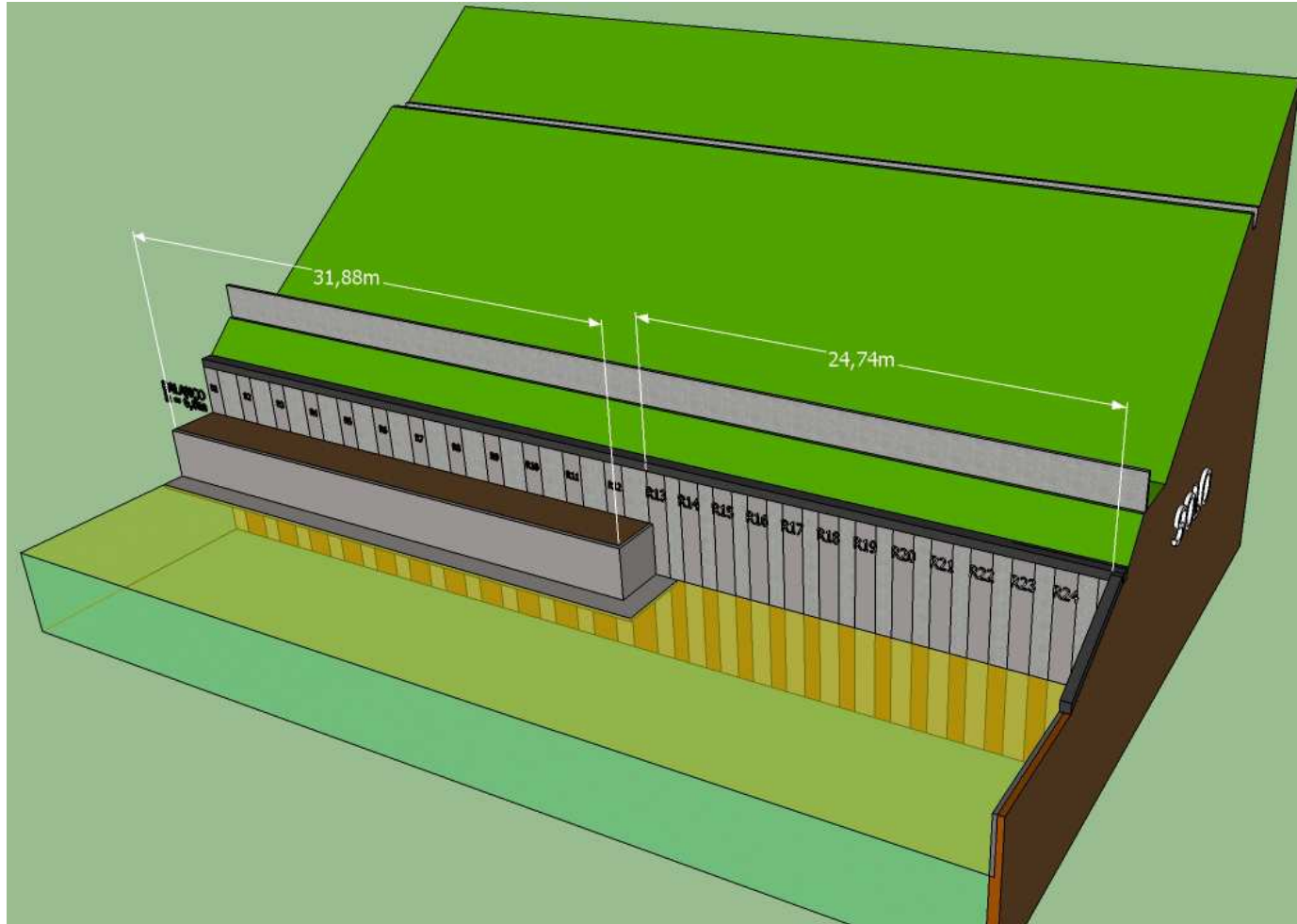
Figura 3.24 - Visualização da contenção antes da ruptura
