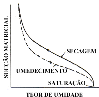
Figura 2. 7: Curvas características por umedecimento e secagem ( Hillel, 1971 apud Calle,2000, traduzido)
