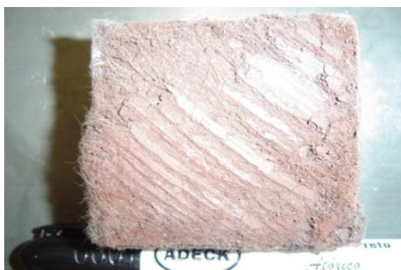
Figura 3.9 - Acúmulo de minério no geotêxtil
