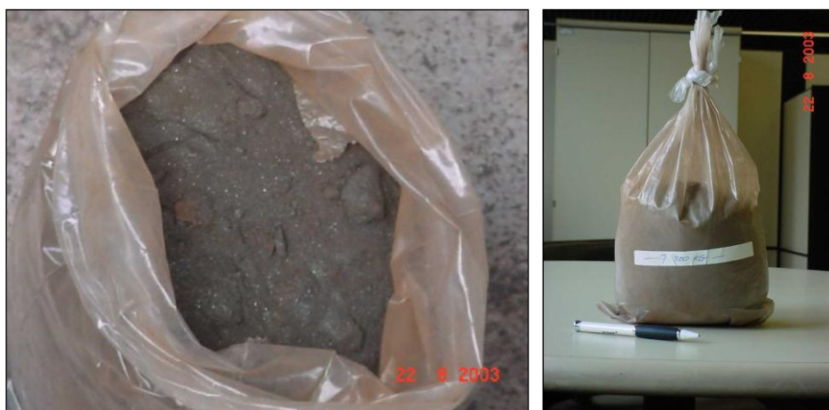
Figura 2.13 - Minério de ferro retirado da caixa coletora instalado na região inferior do dreno (VALE, 2003)
