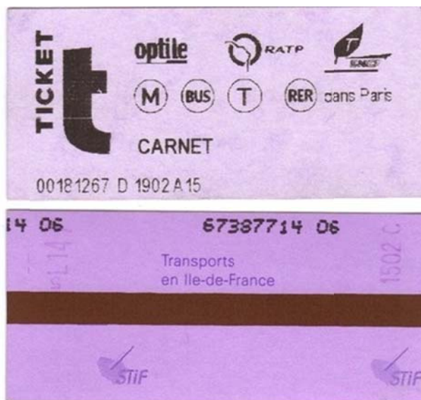
FIGURA 6 - Exemplo do bilhete com tarja magnética tipo Edmonson (metrô de Paris) Fonte: thealteredartstore.com
