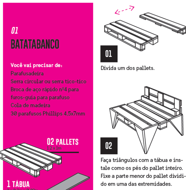
Figura 32 – Instruções para construção de um banco com materiais de baixo custo Fonte: Gorecki et al. (2015).
