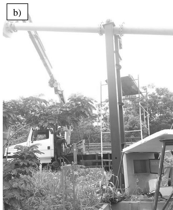
Figura 3.15 – Basculamento do tubo central. a) Basculamento; b) Leitura dos extensômetros.
