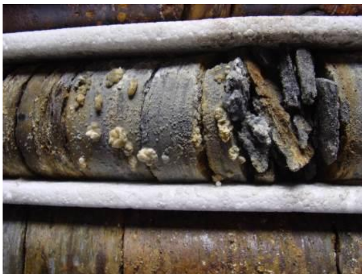
Figura 3.8: Formação de sulfato em testemunho de sondagem, com expansão da rocha. Fonte: CEMIG, 2014
