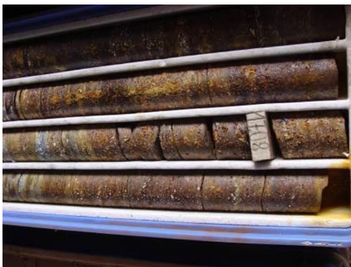
Figura 3.7: Oxidação de testemunho de sondagem. Fonte: CEMIG, 2014
