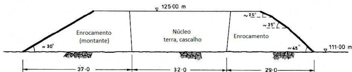
Figura 2.1: Seção transversal da barragem de Sadd El Karafa. Fonte: Melo, 2014
