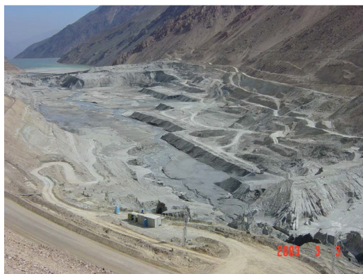
Figura 3.35 – Retomada de rejeito por desmonte hidráulico – Los Bronces (TAILINGS.INFO, 2014).
