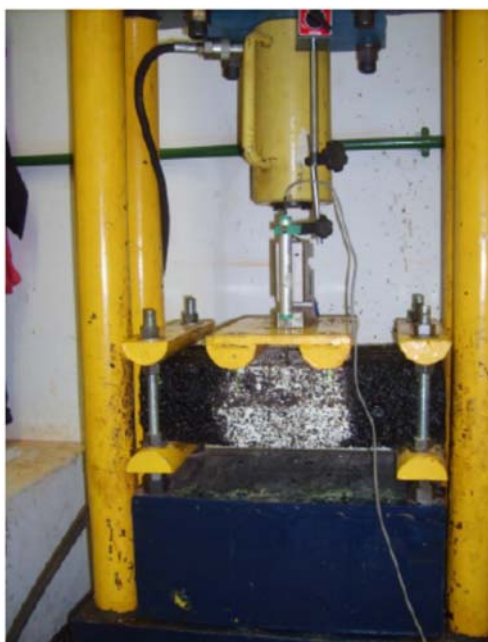
Figura 2.23: Arranjo do ensaio de resistência à tração na flexão estática em misturas asfálticas (OBANDO, 2012).
