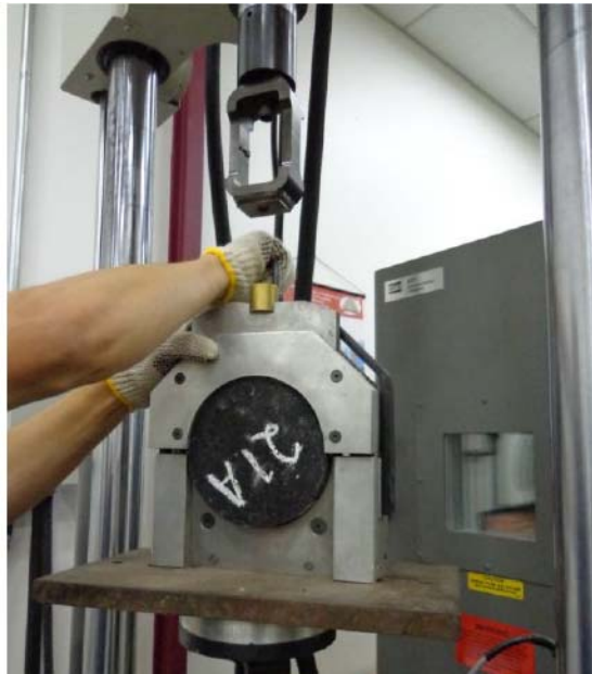
Figura 2.17 Cisalhamento Leutner de mistura asfáltica – Escola Politécnica da USP (GUIMARÃES, 2013).
