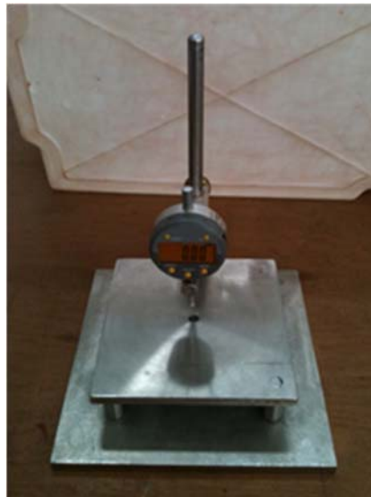
Figura D.1 – Equipamento utilizado para determinação de espessuras (SANTOS, 2013).
