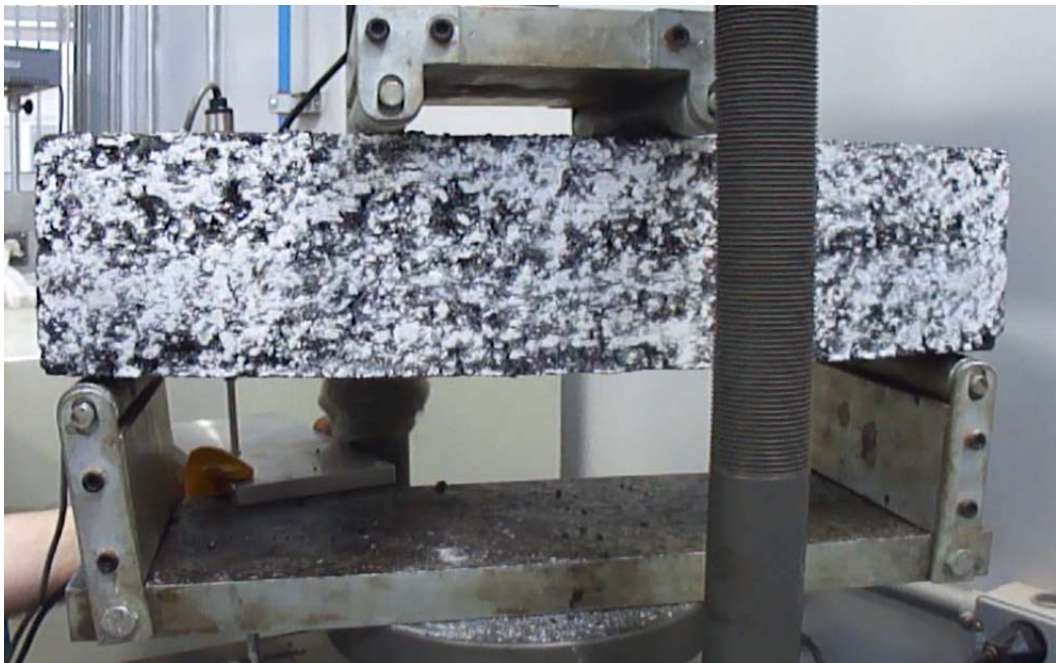
Figura 3.6 – Aparato utilizado para os ensaios de tração na flexão.
