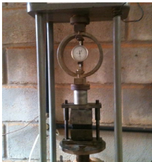
Figura 4.5 – Equipamento preparado com o corpo de prova dentro do molde para determinação estabilidade e fluência nesta pesquisa.
