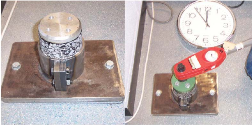
Figura 2.13 – Equipamento para o ensaio de torque em laboratório (CHOI et al., 2005 apud MUSLICH, 2009)
