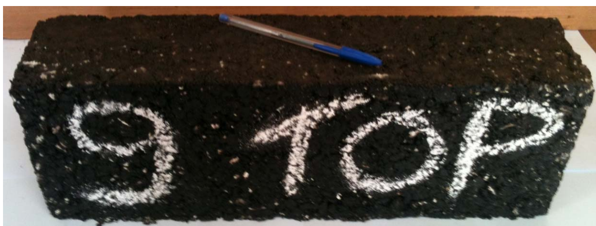
Figura 4.26 – Imagem de um dos corpos de prova utilizados no ensaio de flexão nesta pesquisa.
