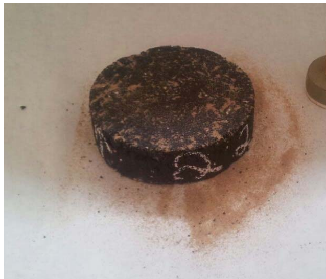
Figura B.1 – Imagem da execução do ensaio modificado de mancha de areia.
