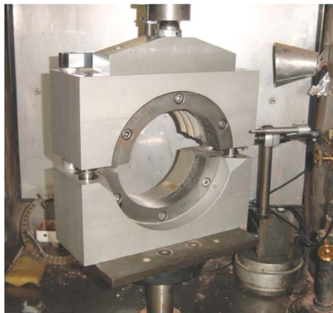
Figura 2.18: Equipamento de cisalhamento Leutner (CHOI et al, 2005, apud MUSLICH, 2009).
