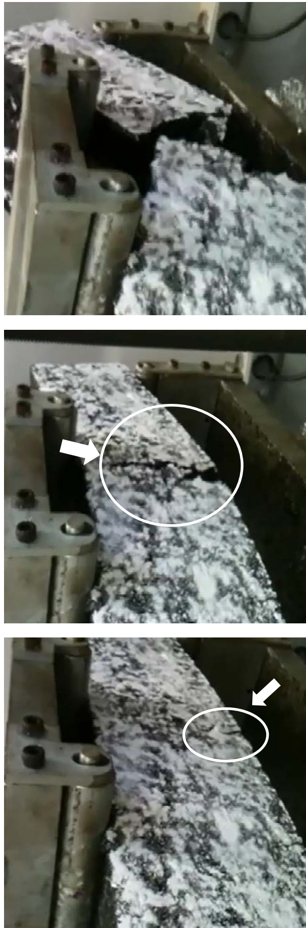
(a) (b) (c) Figura 4.31 – Imagens do ensaio de tração na flexão no sistema sem geossintético: (a) início de formação da trinca; (b) momento intermediário do ensaio e (c) final de ensaio, desligamento da prensa.
