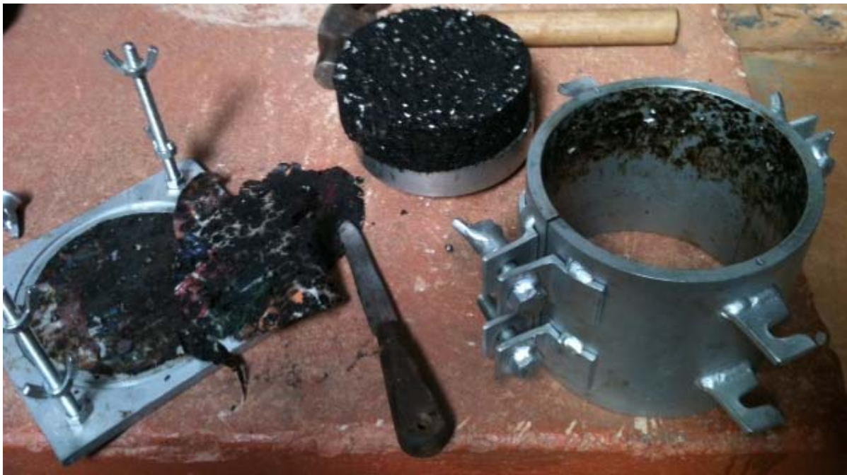
Figura A.1 – Molde bipartido para confecção dos corpos de prova.
