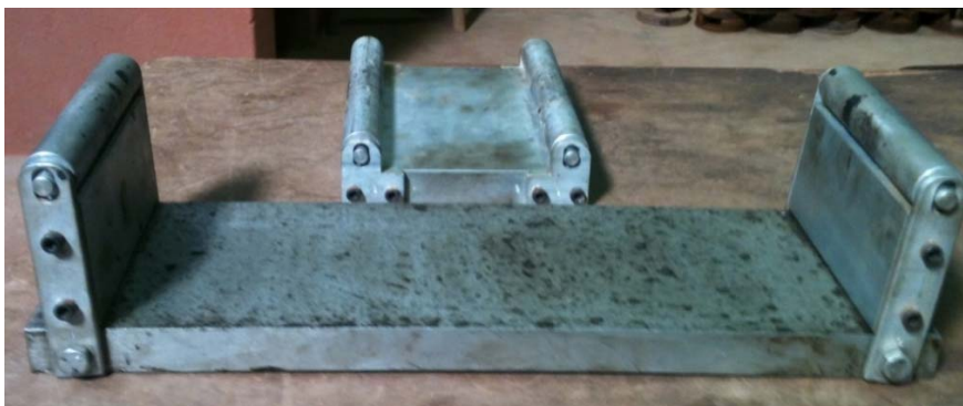
Figura C.2 - Aparato para acomodação do corpo de prova.
