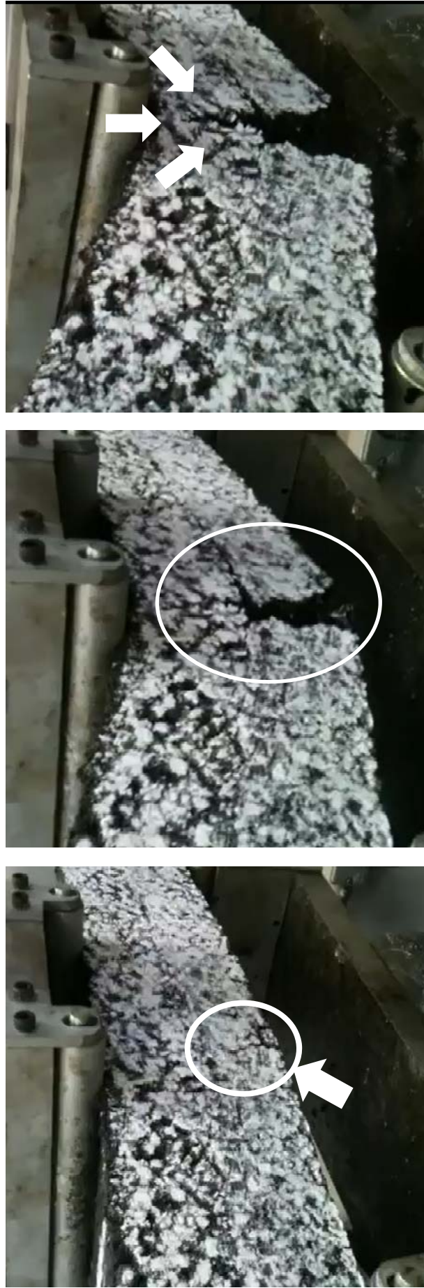
Figura 4.32 – Imagens do ensaio de tração na flexão no sistema com geogrelha: (a) início de formação da trinca; (b) momento intermediário do ensaio e (c) final de ensaio, desligamento da prensa.
