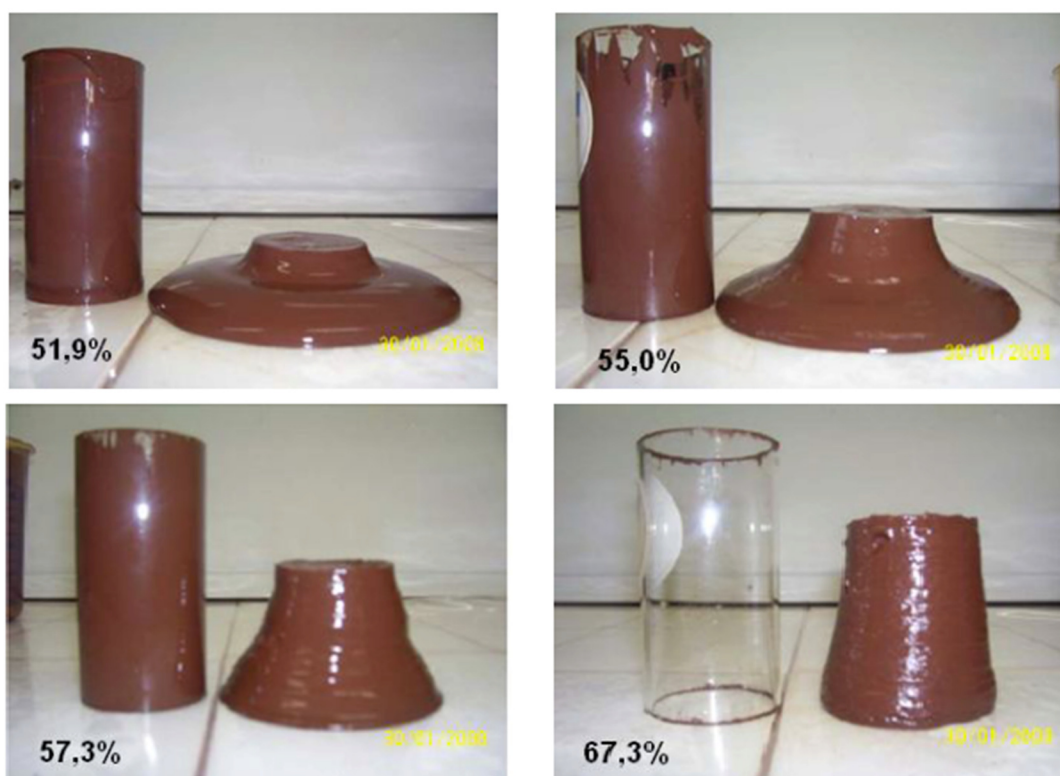
Figura 2.5 - Ensaios “ slump test ” realizados em lamas de minério de ferro da mina Capão Xavier. (GUIMARÃES, 2011)
