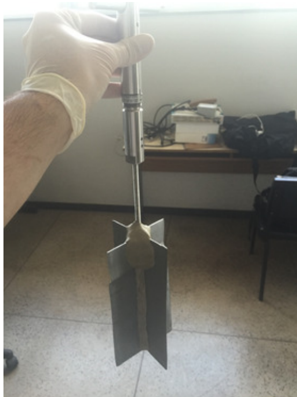
Figura 5.6 - Palheta projetada para aumentar a precisão de medida ( D=100\text{mm} e L=150\text{mm} ).
