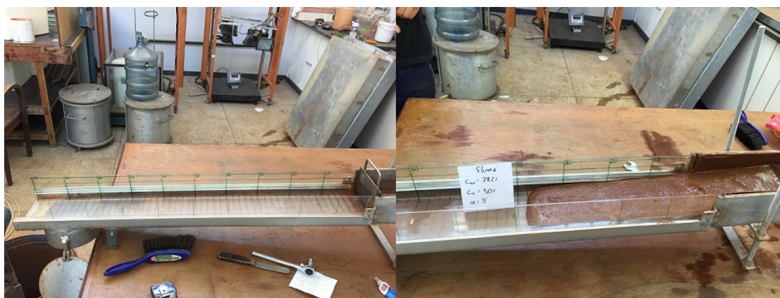
Figura 5.17 - Foto do equipamento de Flume antes e durante o desenvolvimento de um ensaio.
