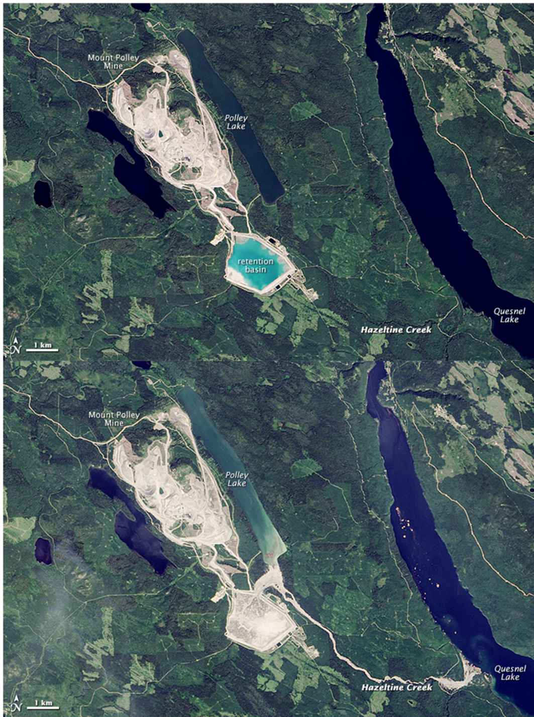
Figura C43 – Imagem de satélite da barragem Mount Polley antes e depois da ruptura.
