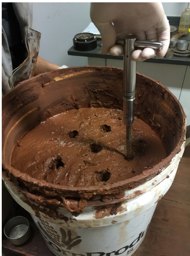
Figura 5.5 - Ensaio de Mini Vane em execução.
