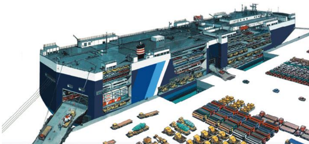
Figura 4.15 – Navio Roll-on / Roll-off para transporte de automóveis Fonte: NYK Line (2015)
