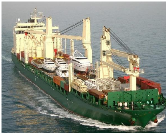
Figura 4.18 - Navio do tipo LO-LO para o transporte de diversos tipos de produtos Fonte: Trans Global Auto Logistics (2015)
