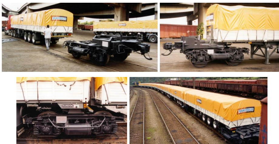
Figura 4.13 – Etapas de conexão do roadrailer em carrocerias rodoviárias Fonte: Ferrovia intermodal (2013)
