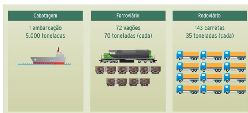
Figura 2.3 – Capacidade de carga: comparação entre os modos de transporte Fonte: CNT (2013a)
