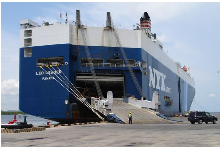
Figura 4.16 – Navio do tipo RO-LO para transporte de automóveis e de carga geral Fonte: Trans Global Auto Logistics (2015)
