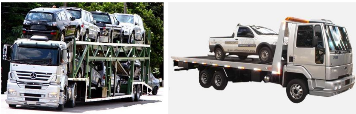
Figura 4.11 – Carrocerias do tipo cegonha e do tipo reboque, respectivamente Fonte: Carolina do Norte (2014)
