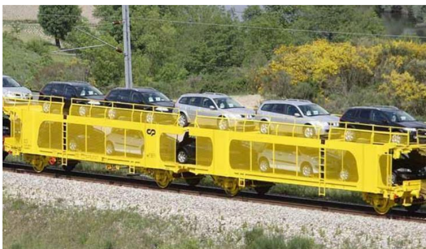
Figura 2.14 – Vagão plataforma de dois pavimentos para transporte de automóveis Fonte: CPCARGA (2011)
